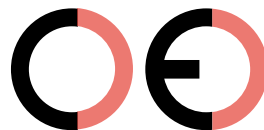
Marcatura CE contraffatta (troppo distante)
